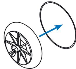
Rohr-Absperrscheibe in Wandeinbauhülse schieben und spannen
